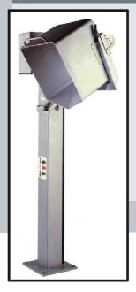
Elevación de los carros mediante tornillo sin-fin y tuerca sobredimensionados.
