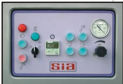
Estas máquinas son gobernadas mediante un cuadro de mandos con TEMPORIZADOR Y PROGRAMADOR INTERNO de ciclos de trabajo que permite seleccionar:
